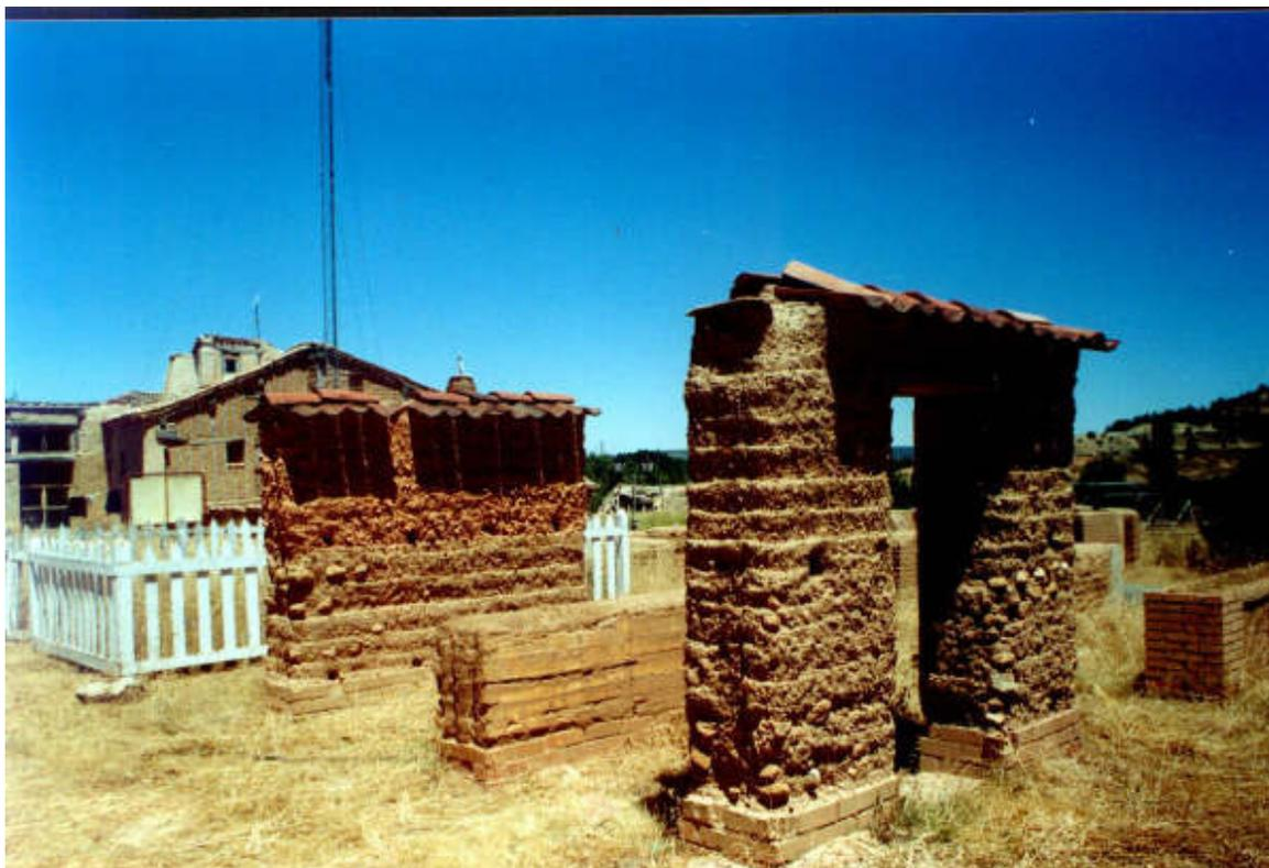
**Foto 3.5** – Muros de testes construídos utilizando várias técnicas e expostos as mais diversas condições climáticas. Fundação Navapalos / Espanha (a Fundação Navapalos promove pesquisas nas áreas de arquitetura de terra, bioclimática e construções de baixo custo).
