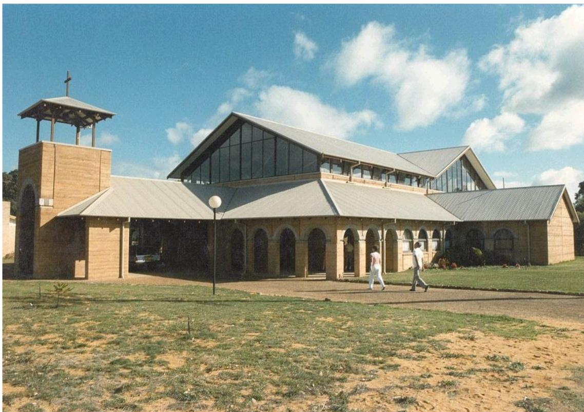
**Foto 7.2** – Igreja construída utilizando técnica construtiva de terra (Rammed Earth).
