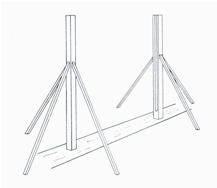
**Figura 6.1** – Instalação das guias e escoramento.
